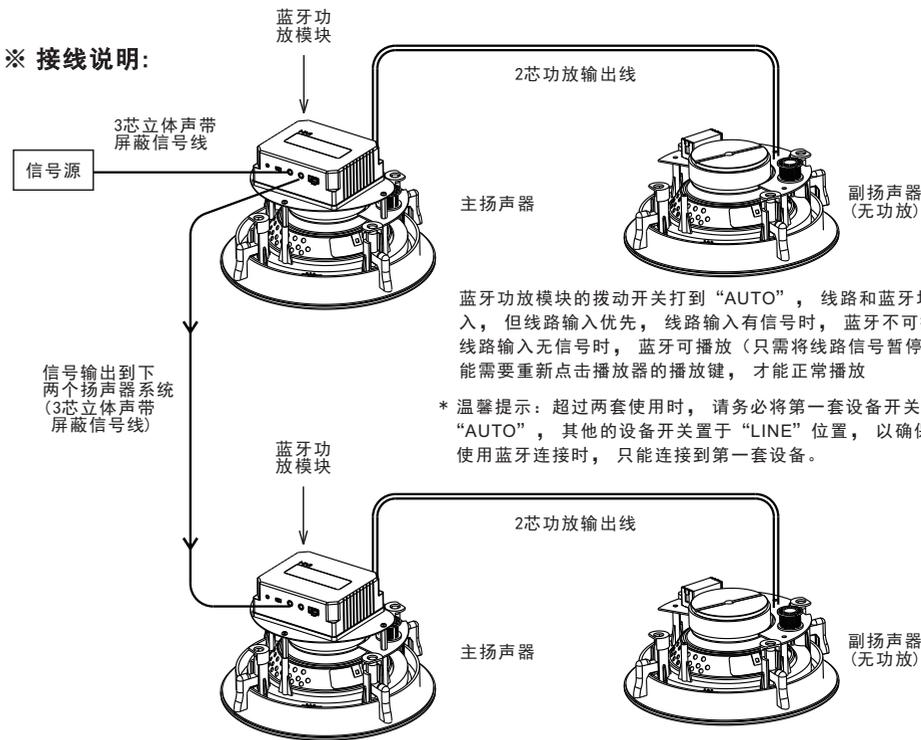
蓝牙功放模块的拨动开关打到“**AUTO**”，线路和蓝牙均可输入，但线路输入优先，线路输入有信号时，蓝牙不可播放，线路输入无信号时，蓝牙可播放（只需将线路信号暂停），可能需要重新点击播放器的播放键，才能正常播放
